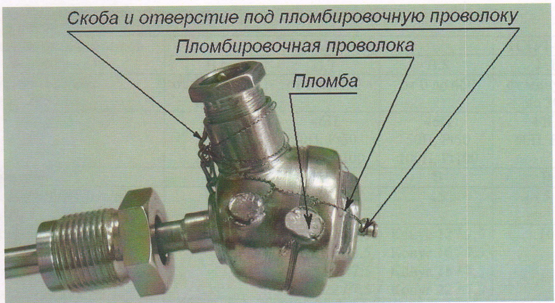
Рисунок 2 – Схема пломбирования термометров сопротивления с металлическими головками
