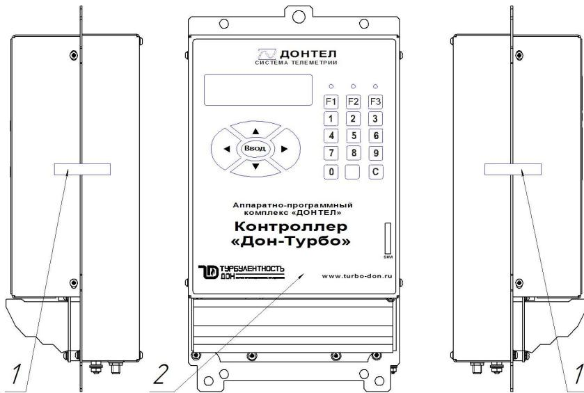
1 – самоклеющаяся пломба в виде наклейки из легкоразрушаемого материала;
