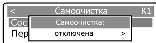
Нажатием клавиши [ВВОД] подтвердить выбранный параметр состояния, на дисплей выводится сообщение об изменении настроек. Для выхода в подпункт «Состояние» нажать [С].
