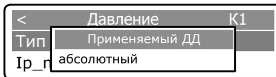
Повторным нажатием клавиши [ВВОД] активизируется режим выбора типа датчика:
