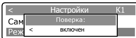
Нажатием клавиши [ВВОД] подтвердить выбранный параметр состояния, на дисплей выводится сообщение об изменении настроек. Для выхода в подпункт «**Режим поверка**» нажать [ C ].
