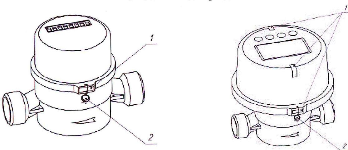
Рисунок 3 - Схемы пломбирования счетчиков воды Гранд СВ
