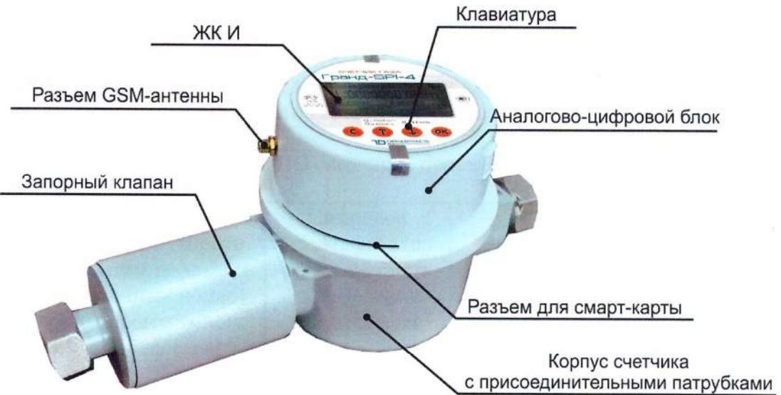
Рисунок 1 – Внешний вид счетчиков газа Гранд - SPI
