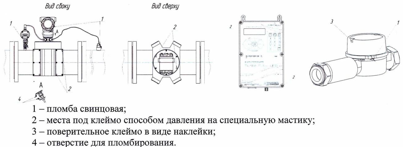
Рисунок 2 - Схемы пломбирования
