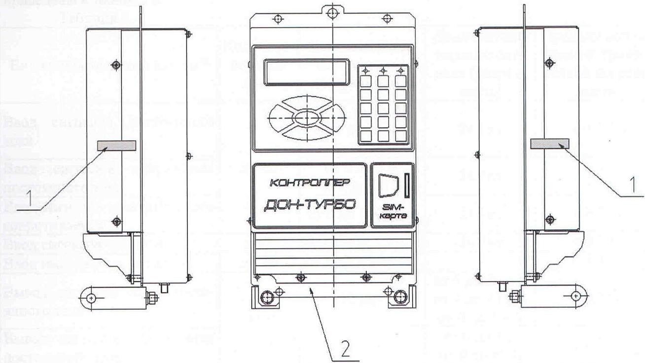
1 - пломба в виде наклейки из легкоразрушающего материала;
