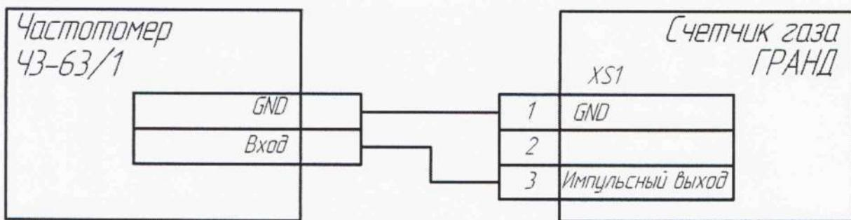
Рисунок 1 - Проверка импульсного выхода
