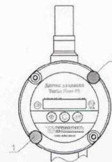
Рисунок Б.1 - Схема пломбирования датчика давления Turbo Flow PS.
