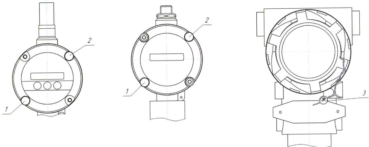
Рисунок 2 - Схемы пломбирования уровнемеров Turbo Flow LVG
